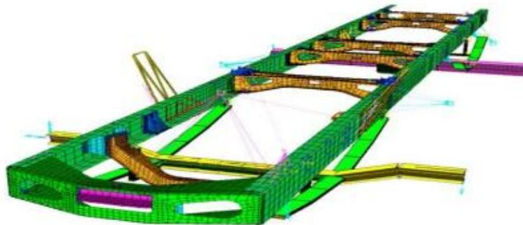
**Figura 5.** Malha de elementos finitos do chassi de caminhão.
