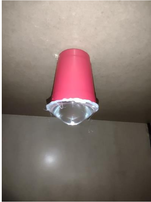
Figura 29 - Lâmpada acoplada à tampa da caixa de MDF.
