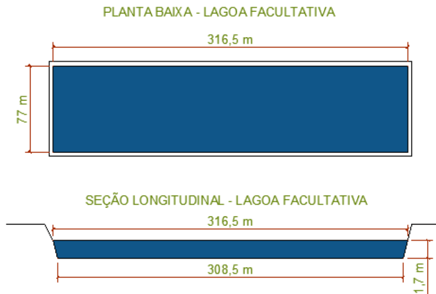
Figura 21: Detalhes da planta baixa e seção longitudinal das lagoas facultativas Fonte: Autor (2022).
