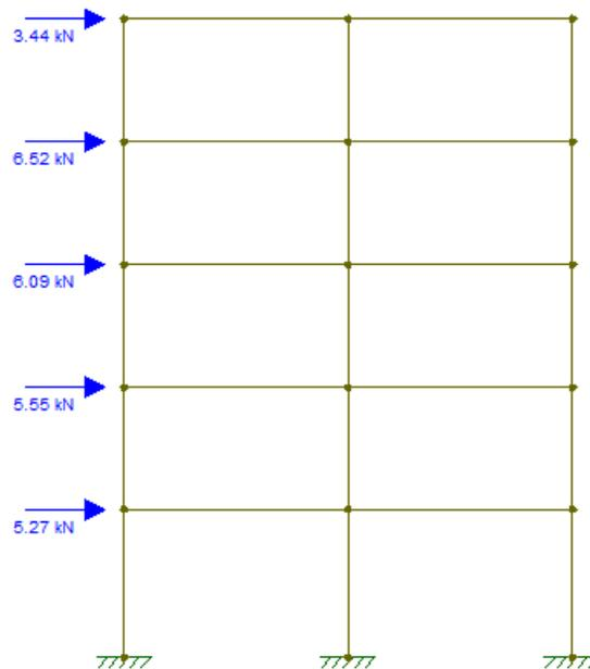
**Figura 16** - Carregamento do pórtico devido ao vento.
