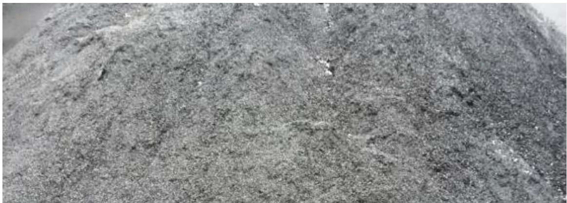
Figura 7 - Cinza retirada do local de armazenagem da UTE Fonte: UTE São Sepé (2021)
