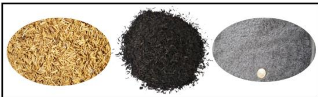
Figura 1 - (a) Casca de arroz proveniente da colheita do arroz in natura, (b) CCA com alto teor de carbono e (c) CCA com menor teor de carbono.
