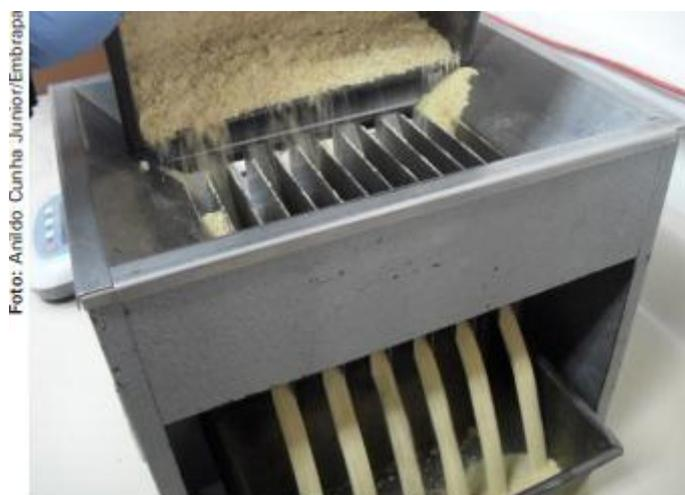
Figura 5: Processo de quarteamento da amostra
