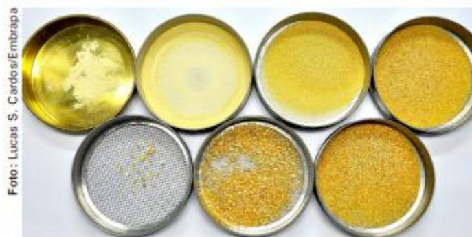
Figura 8: Separação das partículas após o processo de vibração
