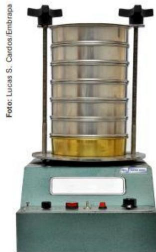
Figura 7: Conjunto de peneiras e aparelho de vibração eletrônica
