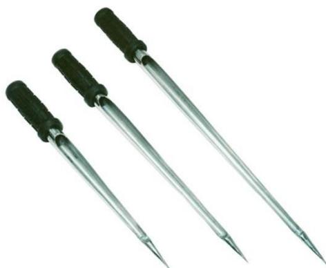
Figura 11: Instrumento para coletas de amostras de matérias primas ensacadas
