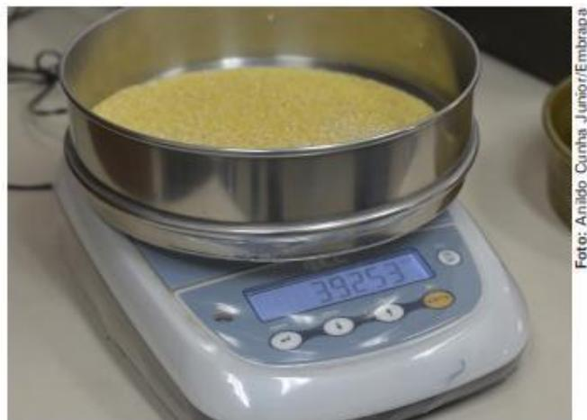
Figura 9: Pesagem das amostras retidas em cada peneira
