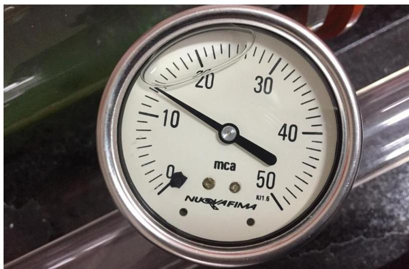
Figura 5: Manômetro com a pressão utilizada nos ensaios.
