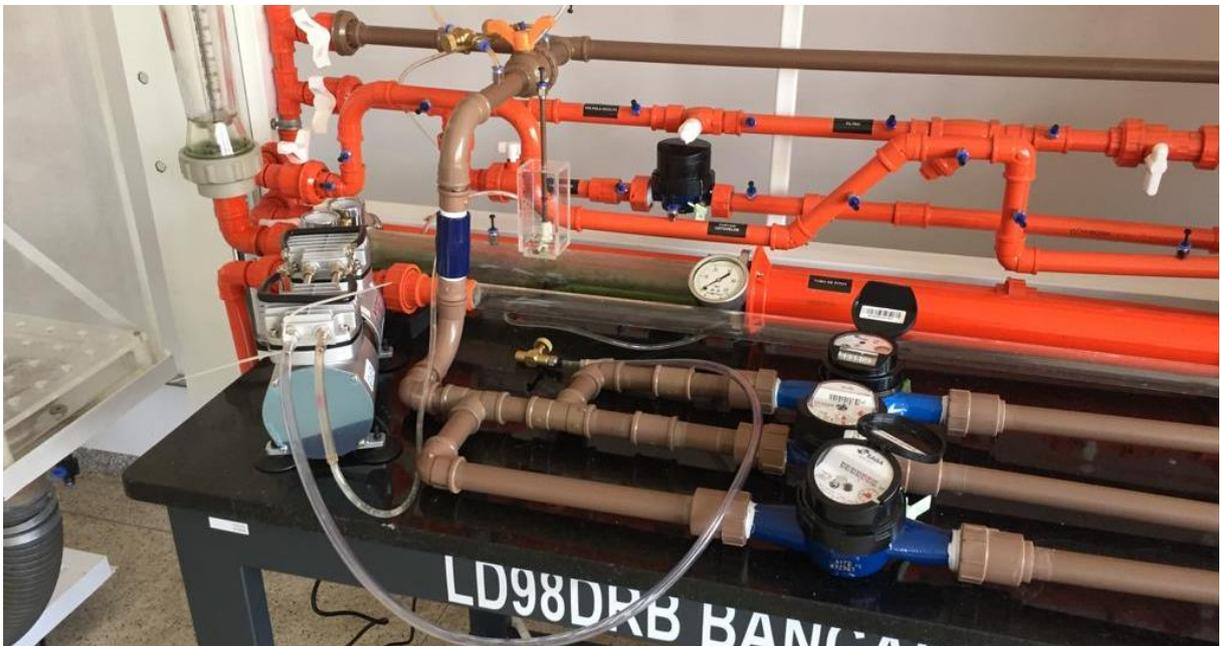
Figura 9: Ramal com inserção de ar e válvula de retenção.
