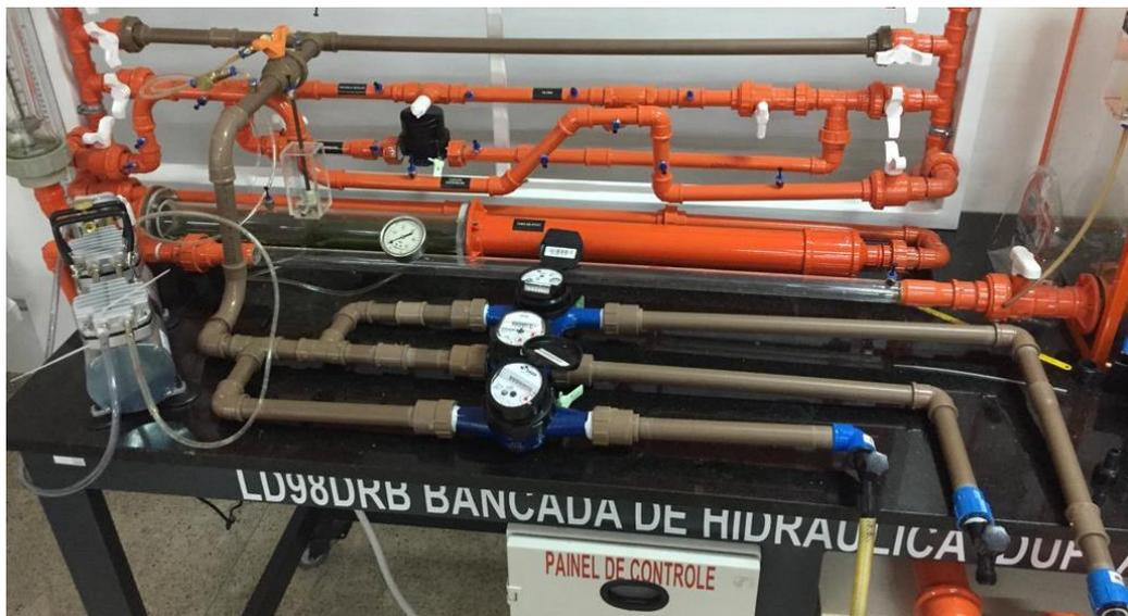
Figura 8: Ramal com inserção de ar.
