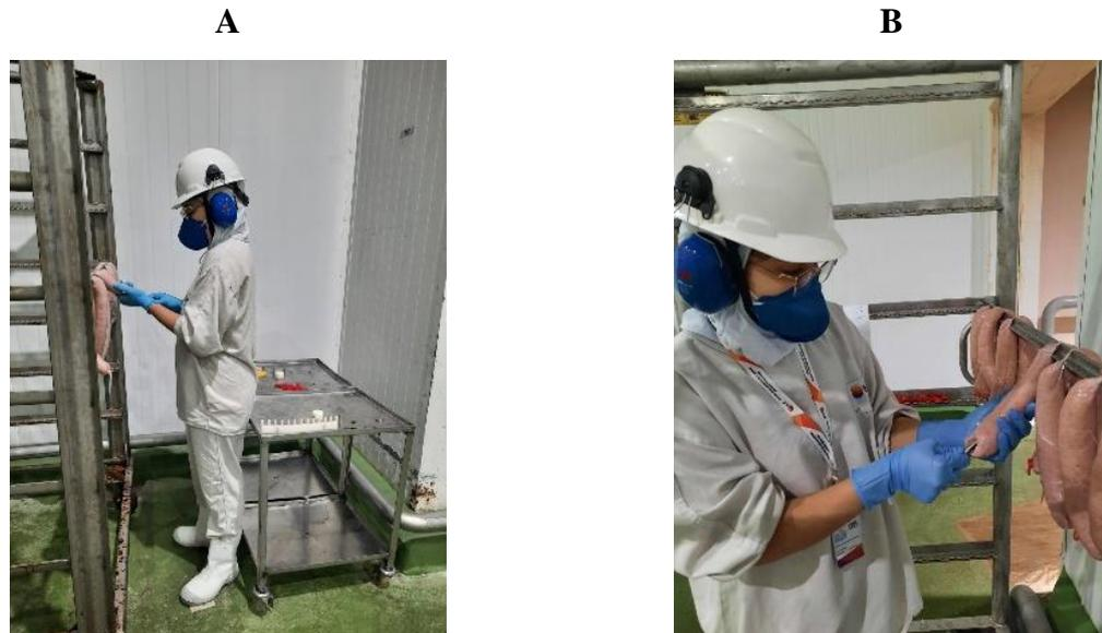
**Figura 3** – Inserção dos termo-registradores nas linguiças tipo calabresa dispostas na vara no suporte para o cozimento
