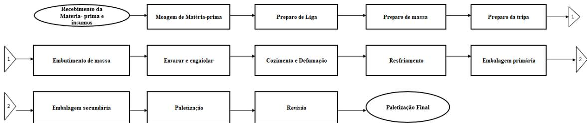
**Figura 2** – Fluxograma de processamento da linguiça tipo calabresa da indústria
