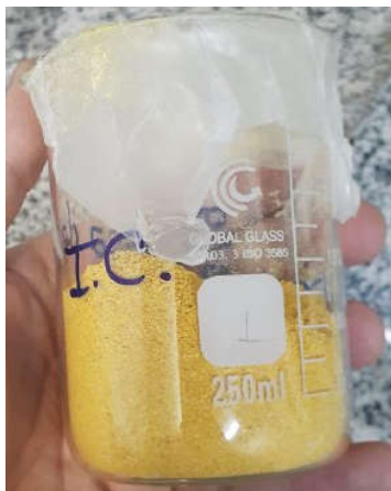
Figura 4 – Biomassa de casca de abóbora in natura após desidratada, triturada e peneirada.
