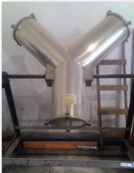
**Figura 18.** Pré-Misturador tipo Y
