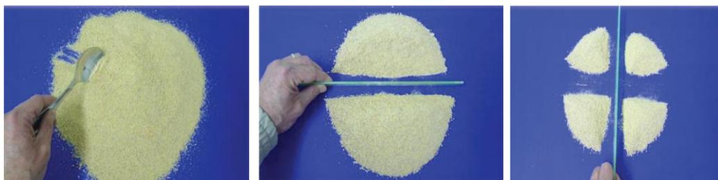
**Figura 4** - Homogeneização manual da amostra, divisão em quatro partes iguais.
