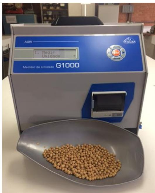
**Figura 6:** Determinador de umidade G 1000
