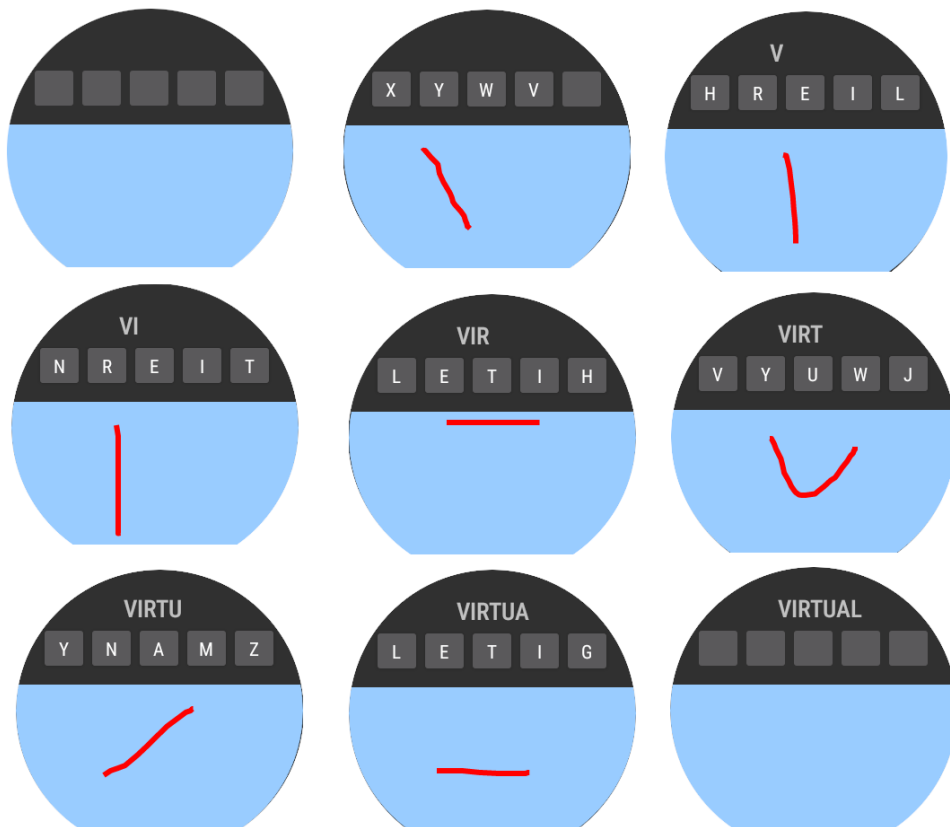
Figura 4.5: Passos para inserção da palavra “VIRTUAL” no smartwatch utilizando o protótipo desenvolvido.
