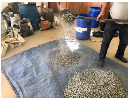
Figura 5 - Processo de mistura do agregado que estava segregado antes dos ensaios Fonte: O autor (2021).
