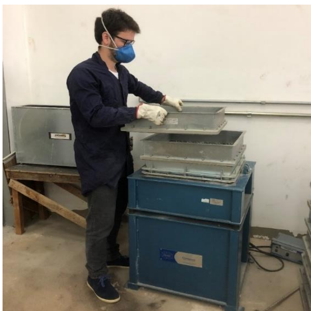
Figura 3 - Processo de peneiramento dos agregados entre as peneiras 3,35 e 19,00 mm Fonte: O autor (2021).
