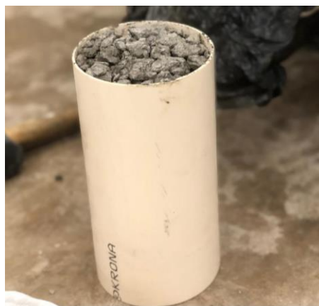
Figura 11 - Corpo de prova utilizado no ensaio de permeabilidade e percentual de vazios Fonte: O autor (2021).
