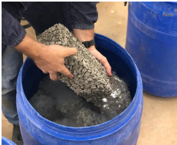
Figura 8 - Colocação dos corpos de prova em tambor com água por 28 dias Fonte: O autor (2021).
