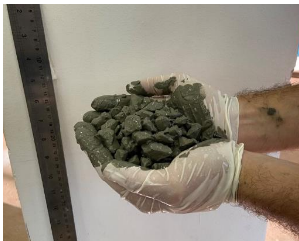
Figura 6 - Avaliação do estado da massa de concreto Fonte: O autor (2021).
