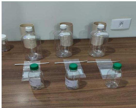
**Figura 7.** Frascos de coleta utilizados para todos os pontos. Fonte: CASTRO (2021)
