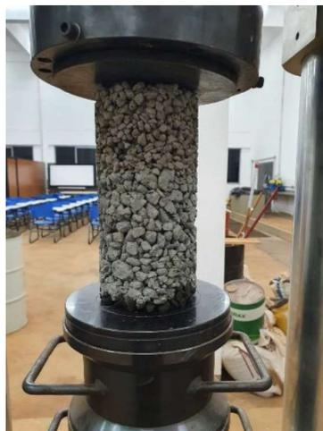
Figura 8 – Ensaio de resistência à compressão
