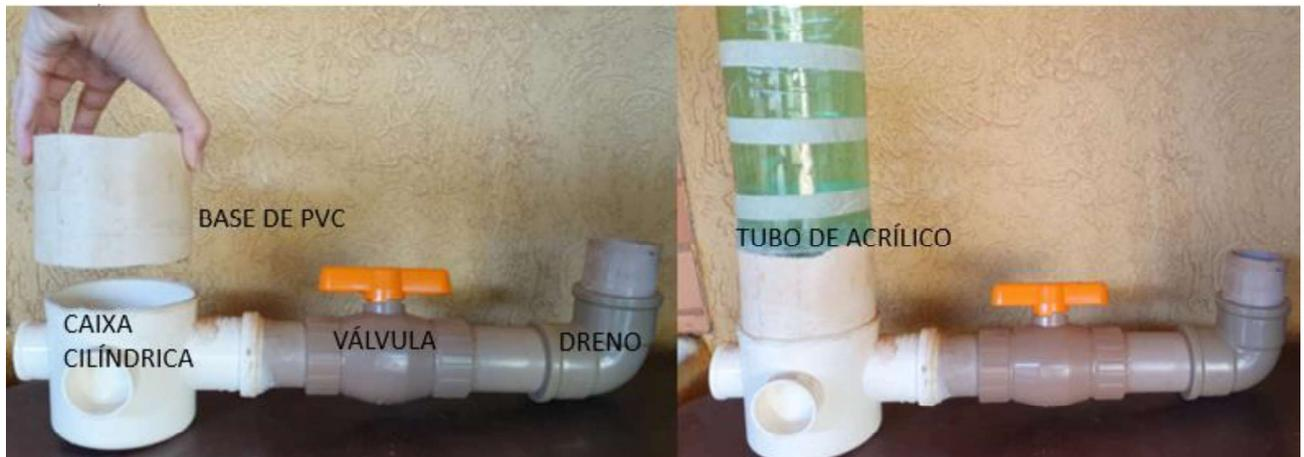
Figura 5 – Permeômetro construído para determinação de coeficiente de permeabilidade.
