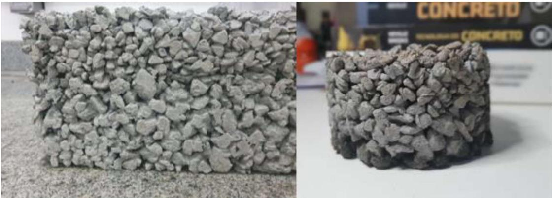
Figura 3 – Corpo de prova de agregado 1 + agregado 2
