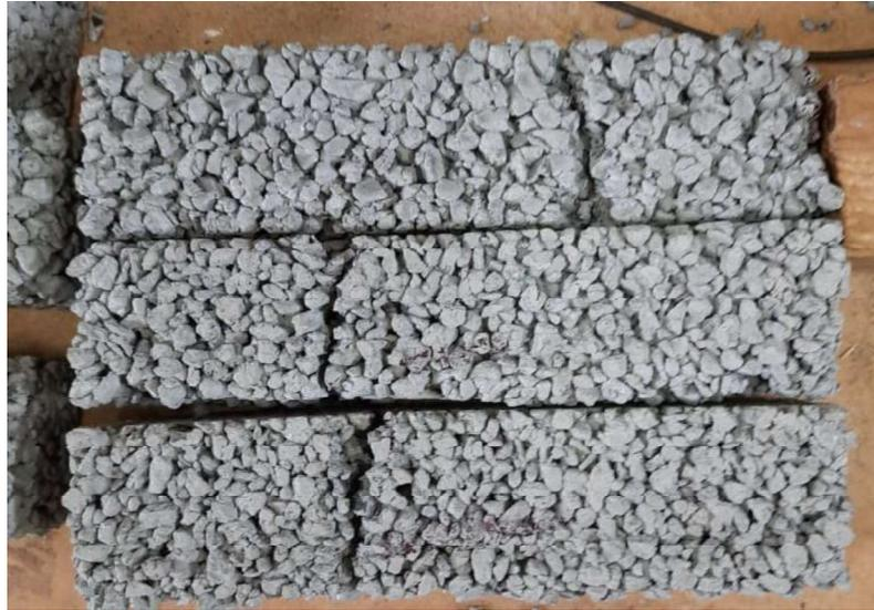
Figura 11 – Fissuras após ensaio de resistência mecânica.
