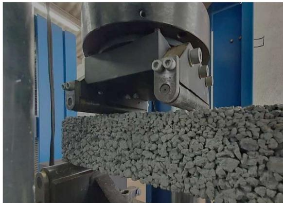
Figura 7 – Ensaio de resistência à tração na flexão.
