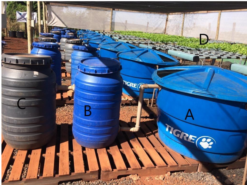
Figura 3. Constituintes do sistema de aquaponia que conta com um tanque de criação de peixes de 1000 L (A), decantador de 200 L (B), filtro biológico de 200 L (C) e calhas hidropônicas de 6 m (D).
