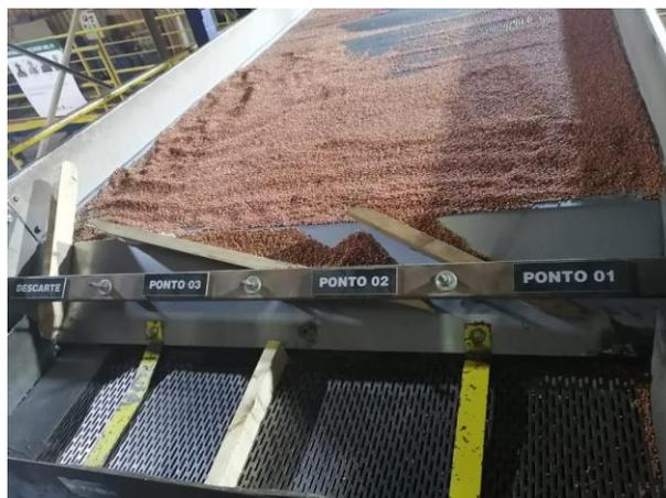
Figura 2 – Mesa densimétrica utilizada no experimento
