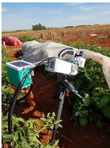
Figura 03 - Analisador gasoso por infravermelho, IRGA (LI-6800, LI-COR Inc., Lincoln, NE, USA) fazendo as leituras de trocas gasosas nas plantas de tomateiro, Morrinhos – GO, 2019.
