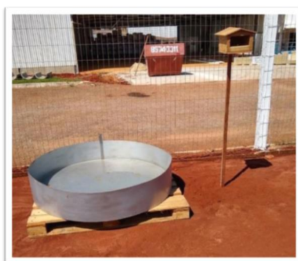
Figura 4. Tanque Classe A e abrigo para termo-higrômetro instalado no local do experimento
