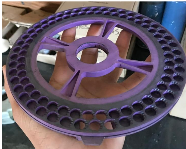
Figura 04 - Disco de soja 90 furos RampFlow®. Fonte: Arquivo pessoal (2020)
