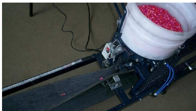
Figura 05 - Esteira Utilizada em Testes de Plantabilidade. Fonte: Okponik (2012)
