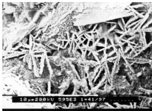
Figura 10 - crescimento cristalino no concreto [47]
