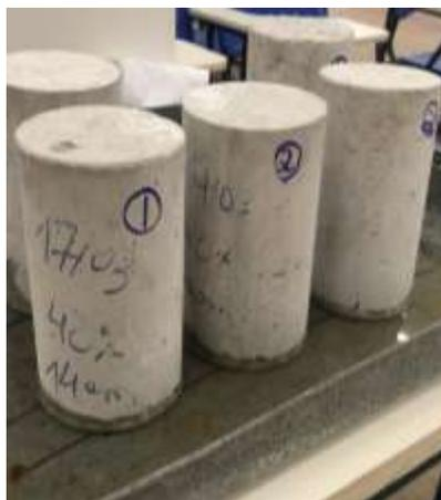
Figura 6: Absorção por capilaridade
