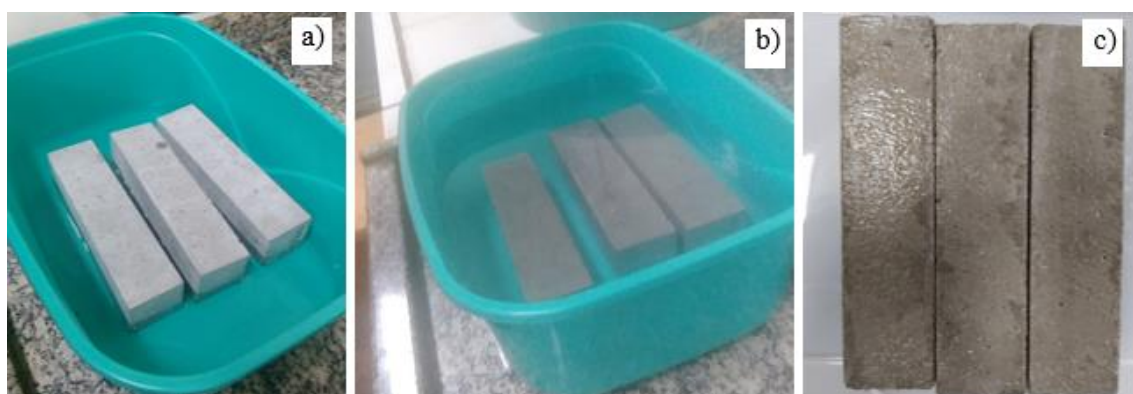
Figura 22 - Ensaio de absorção de água em andamento: a) Corpos de prova após período de estufa e resfriados; b) Corpos de prova submersos; c) Corpos de prova após o banho maria.
