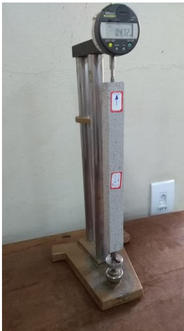
Figura 23 - Corpo de prova com marcação da posição de leitura em medidor padrão.
