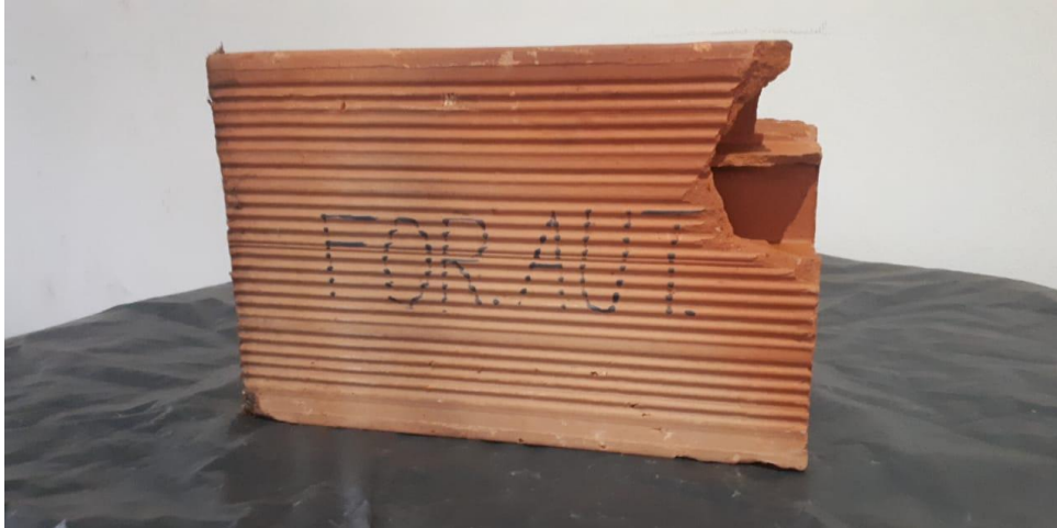
Figura 7 - Ensaio de característica visual – Quebrado – Fornecedor Autônomo. Fonte: Autor, 2021.
