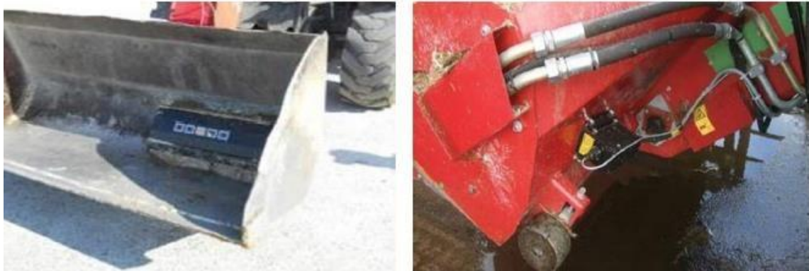
Figura 11. Analisador NIRS acoplado a equipamentos de manejo de alimentos
