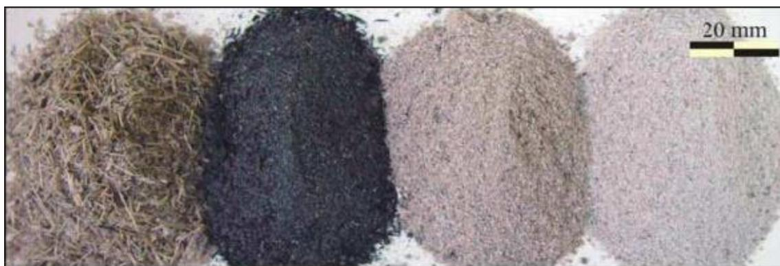
Figura 1 – (a) Bagaço de cana-de-açúcar e diferentes cinzas residuais geradas após a queima do bagaço em caldeira: (b) cinza com alto teor de carbono, proveniente da combustão incompleta, (c) cinza com menor teor de carbono e (d) cinza após combustão completa.
