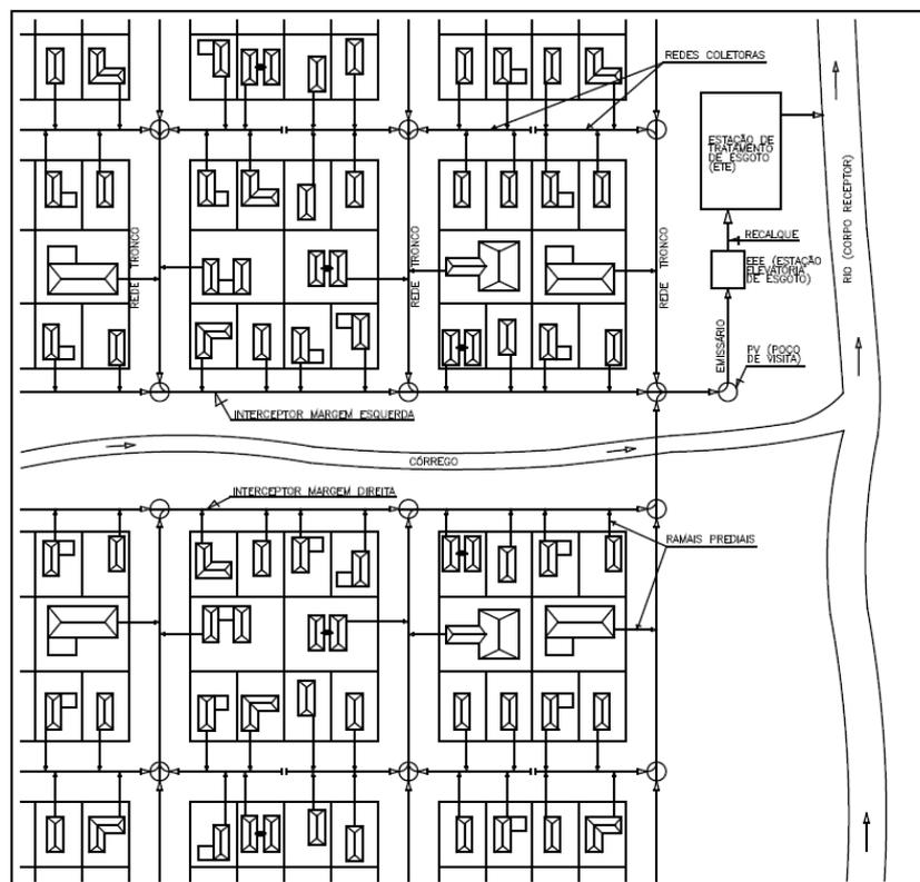
**Figura 1** - Sistema convencional de esgotamento sanitário
