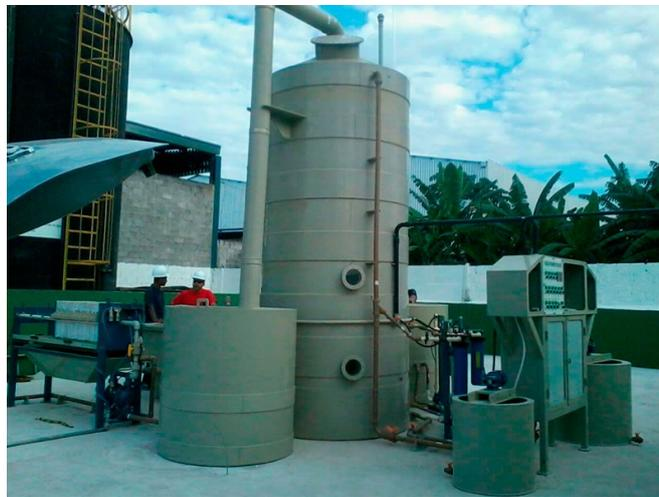
**Figura 4** - Montagem de um sistema de flotação por ar dissolvido (FAD)
