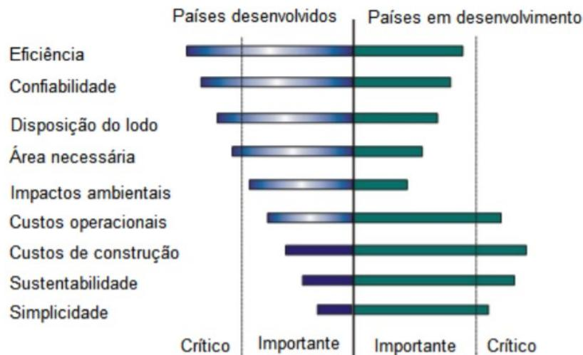
**Figura 18** -Aspectos críticos e importantes na seleção de sistemas de tratamento de esgoto em regiões desenvolvidas e em desenvolvimento
