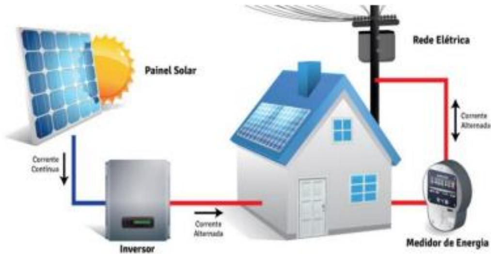
Figura 5. Sistema *On-Grid*
