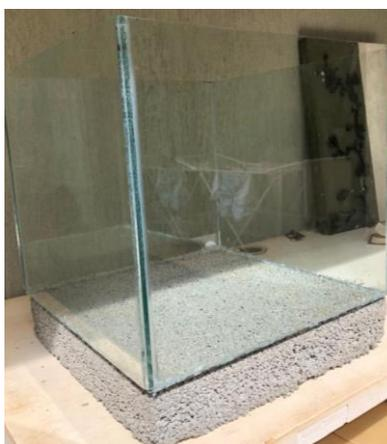
Figura 5- Estrutura para sustentar as camadas do telhado. Fonte: autoral.
