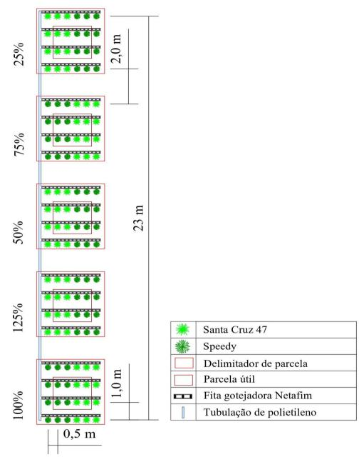
Figura 4. Esquema de um bloco experimental com o sistema de irrigação e detalhe da área útil. Ceres – GO, 2018
