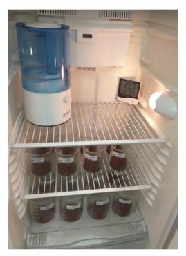
Figura 14 - Análise de biodegradabilidade de filmes de pectina incorporados de nanopartículas de ZnO Fonte: A autora (2020).
