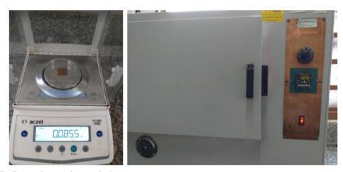
Figura 7 - Determinação de teor de água
