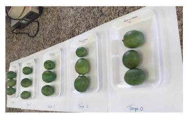
Figura 18 - Disposição das mangas na bancada para pesagem para perda de massa Fonte: A autora (2021).
