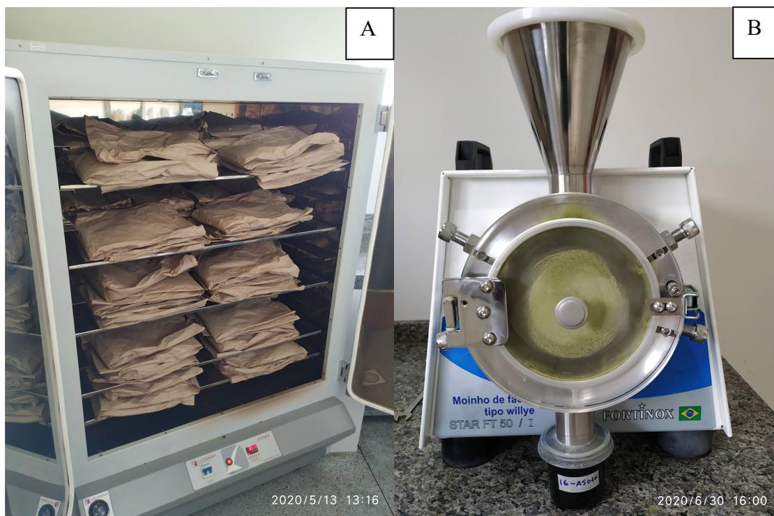
**Figura 2.** A) sacos de papel pardo com as amostras levadas a estufa com circulação forçada de ar; B) Moinho de facas tipo Willey e pó obtido devidamente identificado e mantido ao abrigo da luz. Fonte: Castro, W.J. (2020).
