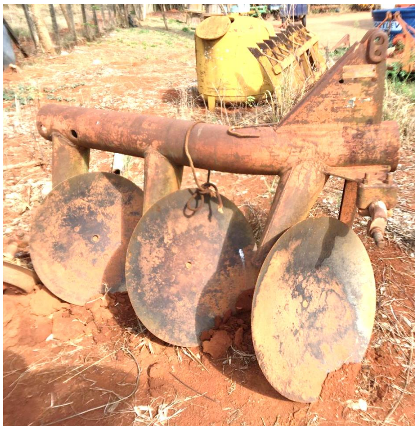
Figura 19 - Arado de discos Massey Ferguson, modelo 204.
