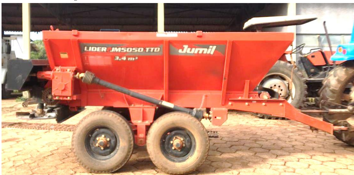
Figura 24 - Distribuidor de adubo Jumil, modelo Líder JM5050TTD.
