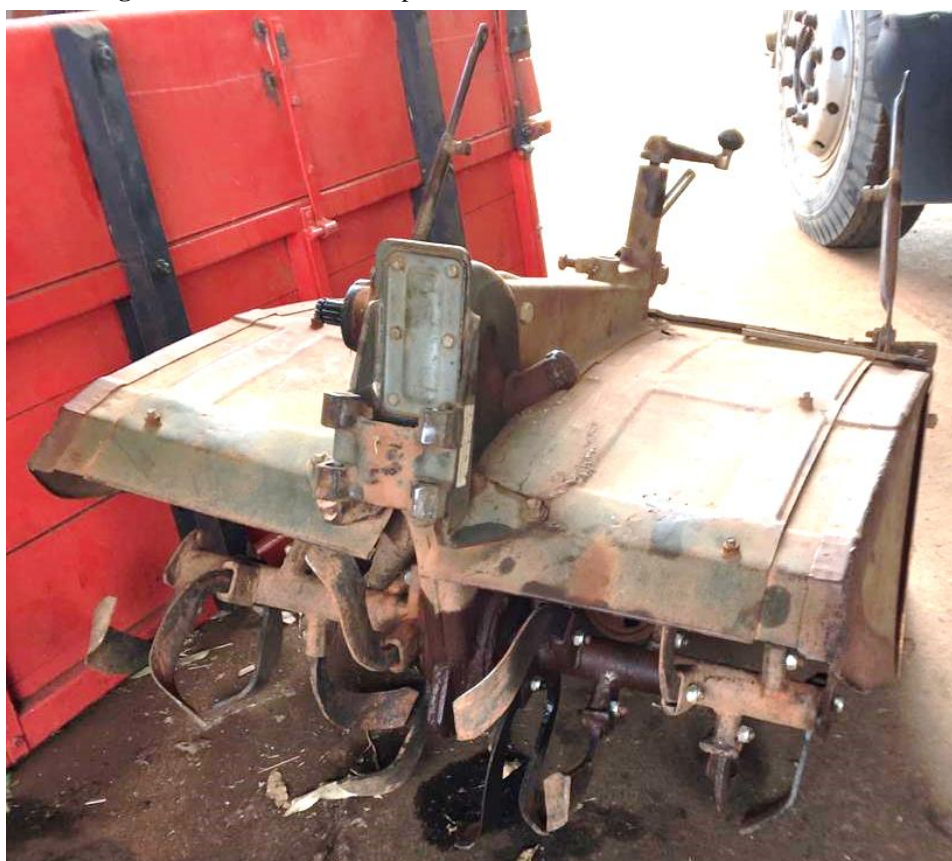
Figura 13 - Enxada rotativa para micro trator da Yanmar, modelo TA49.
