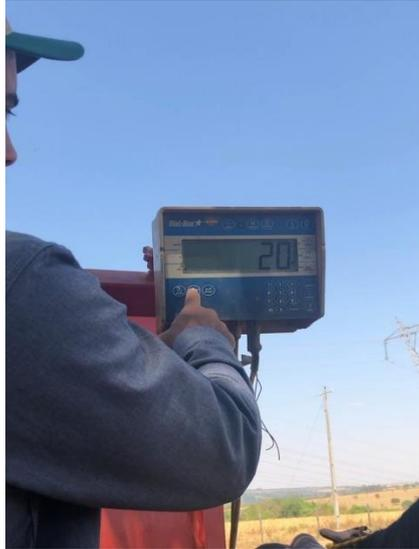
Figura 18 – Programação da dieta na balança do vagão forrageiro.
