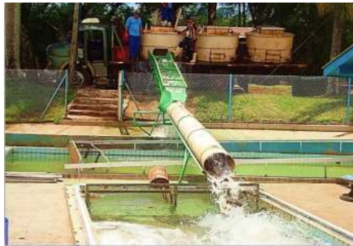
Figura 4. Tanque e sistema de aeração utilizados na depuração. Fonte: Smartfish, 2012
