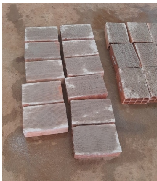
Figura 15: blocos revestidos com água de betoneira. (Fonte: própria autoria).
