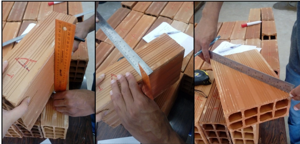
Figura 5: Tomada das dimensões D, F e diagonal. (Fonte: própria autoria)
