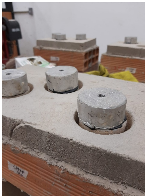
Figura 17: colagem da pastilha na superfície do corpo de prova. (Fonte: própria autoria).
