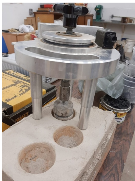
Figura 18: ensaio de arrancamento. (Fonte: própria autoria).
