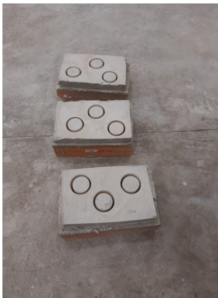
Figura 16: corte dos corpos de prova com serra copo diamantada. (Fonte: própria autoria).
