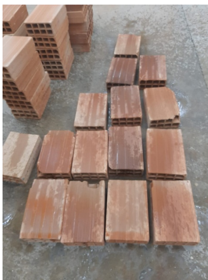
Figura 10: Blocos sem preparo de base e umedecidos. (Fonte: própria autoria).
