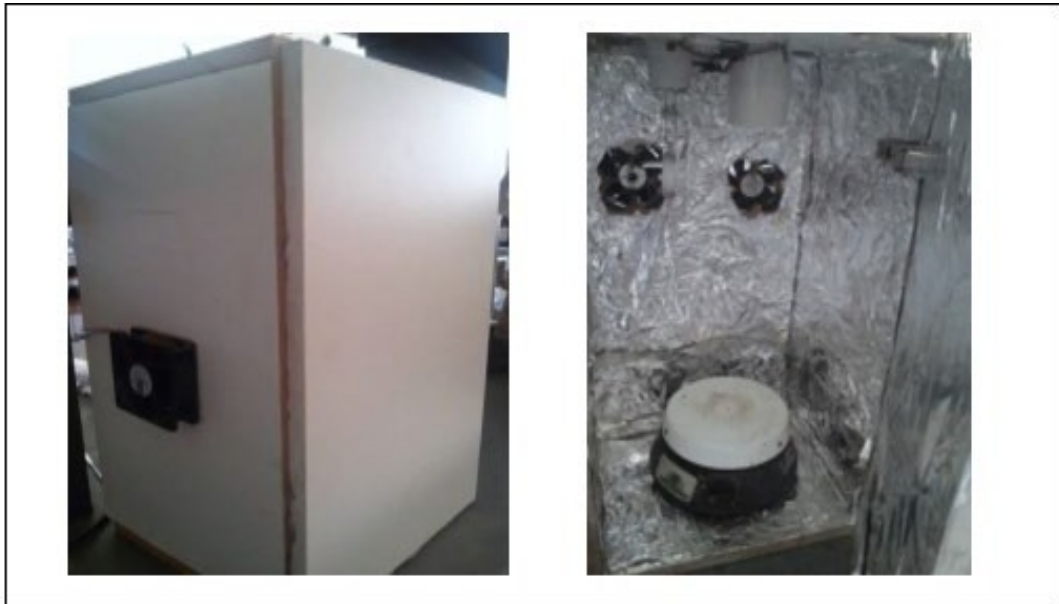
Figura 1 - Câmara de fotorreação equipada com uma lâmpada de vapor de mercúrio 400 Watts, um agitador magnético e coolers para resfriamento.
