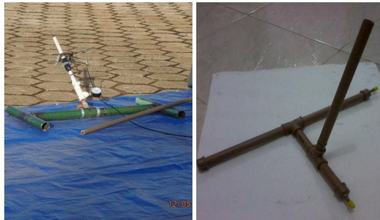
Figura 2: Base de lançamento
