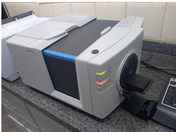
Figura 1. Colorímetro Hunter Lab Color Quest XE (NASCIMENTO, W.V.)
