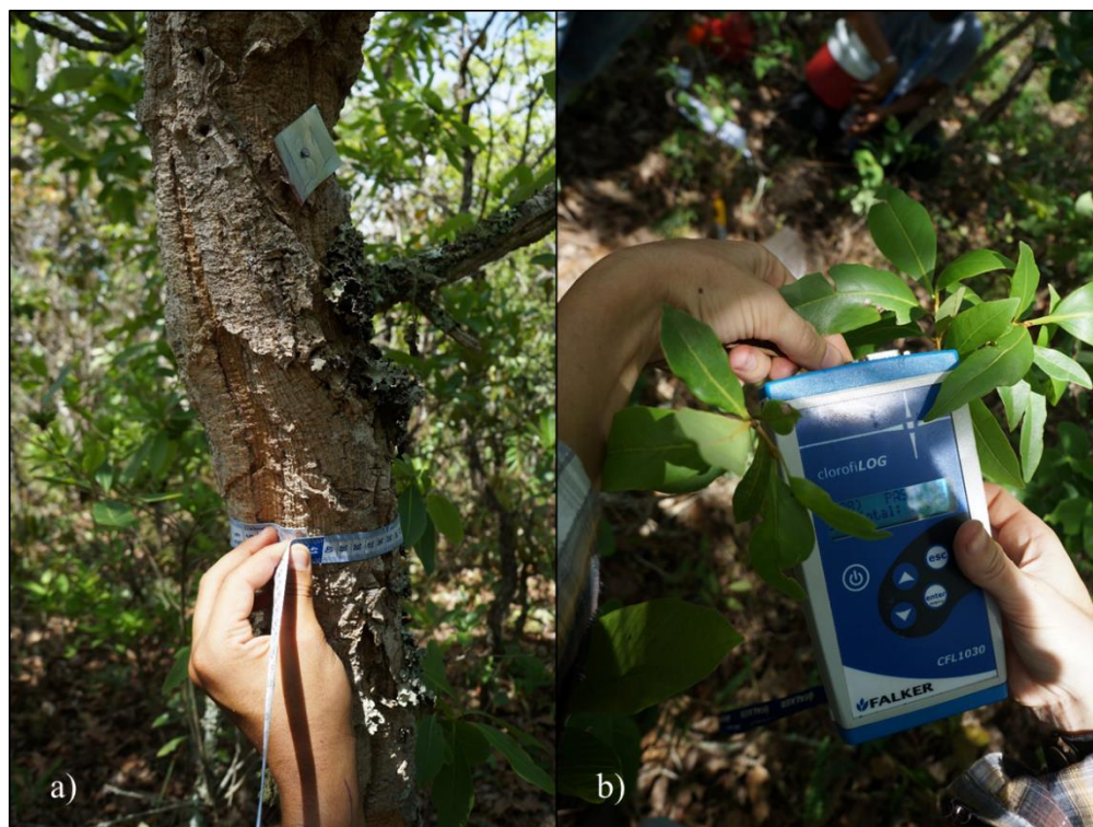
Figura 9A. Coleta de dados em campo. a) Dados de circunferência do caule à altura do peito (CBH) sendo coletados utilizando fita métrica. b) Medição imediata da clorofila a, b e total, utilizando-se ClorofiLOG1030®.
