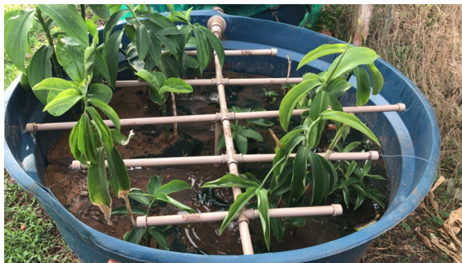
Figura 12 – SAC 2 subsuperficial em fluxo vertical plantado com cana-do-brejo.
