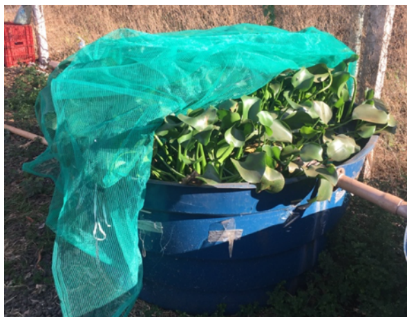
Figura 11 – SAC 1 – Sistema alagado construído fluxo superficial de lagoa de aguapés.
