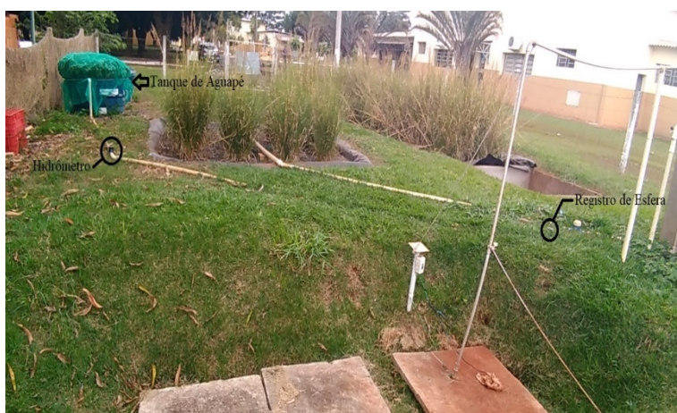
Figura 9 - Visão geral da estação piloto com tanque de aguapé, hidrômetro e registro de esfera destacados.
