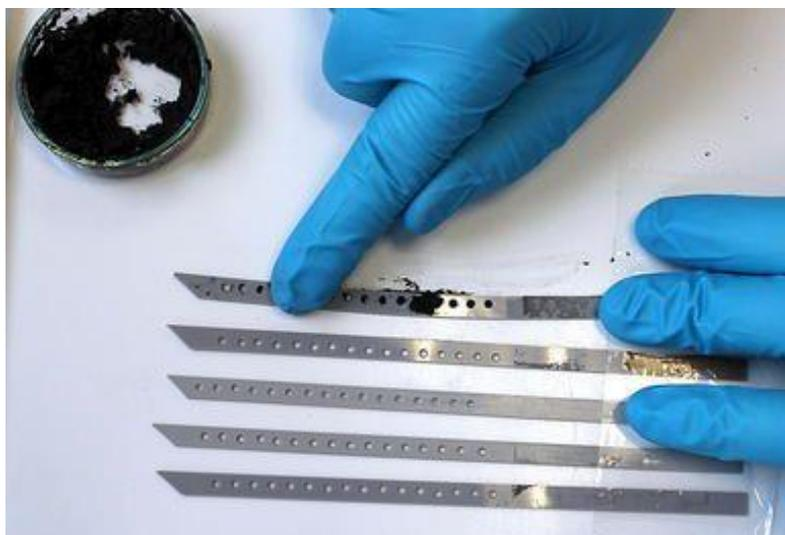
**Figura 2.** Preenchimento de material de isca nas tiras de lâmina de isca.
