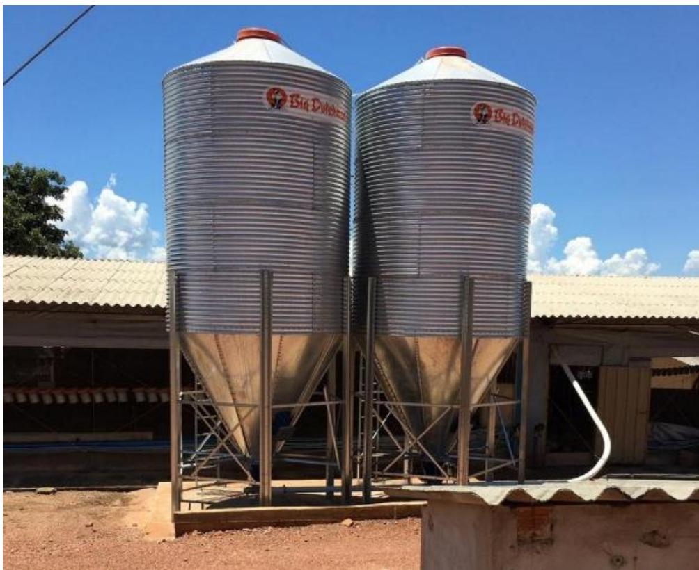
Figura 3– Silo para armazenamento de rações, para a criação de frangos de corte, com capacidade de 18 toneladas. Fonte: Arquivo pessoal, 2020.
