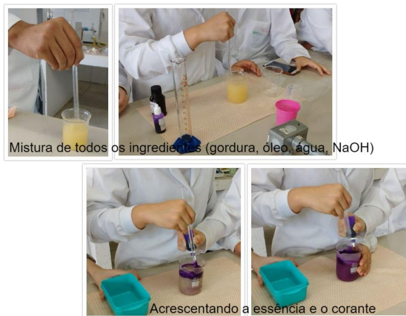
Figura 9: Mistura de todos os ingredientes: gordura vegetal + óleo de canola + água + NaOH + essência + corante.
