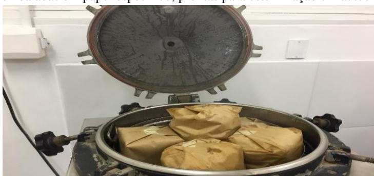
Figura 5: Laboratório de Bacteriologia da EVZ/UFG: Vidrarias embaladas em papel específico, prontas para esterilização em autoclave.
