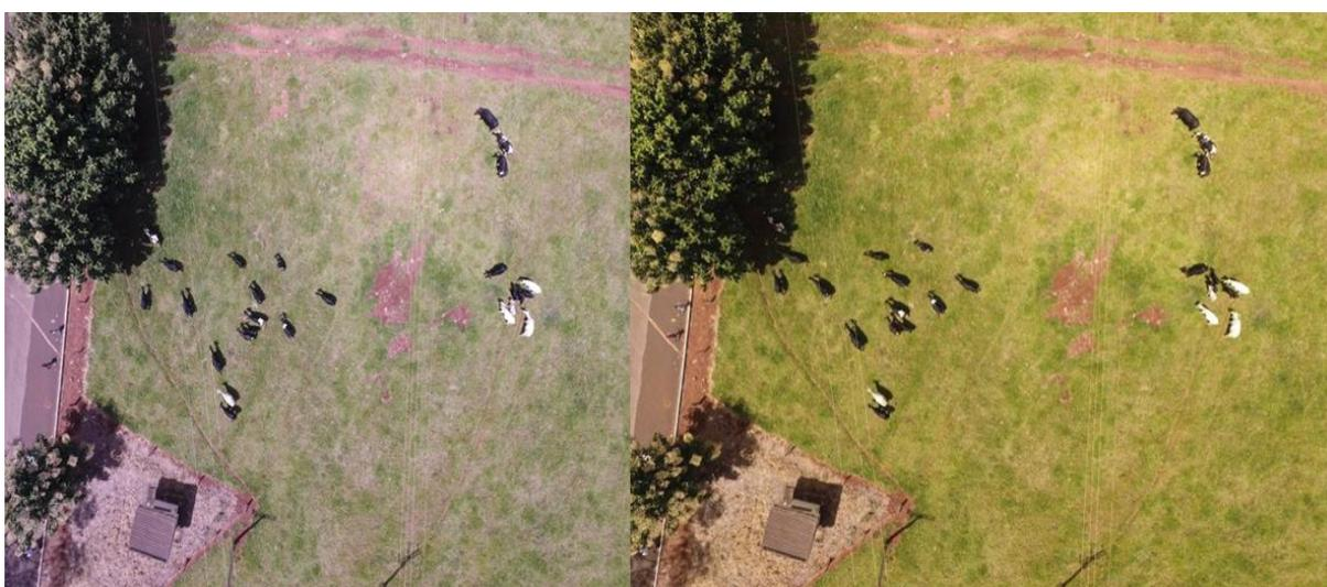
**Figura 8.** Imagens capturadas durante voo de drone a 40 metros de altura, mostrando a influência do reflexo da luz solar sobre a coloração das fotos capturadas por drone (Fonte: Arquivo pessoal).
