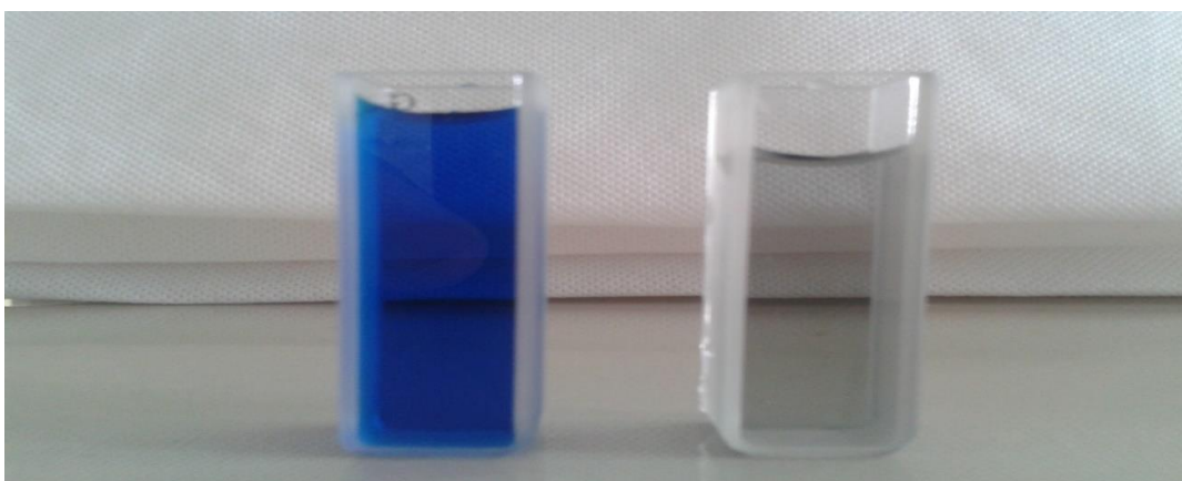
Figura A5: Degradação do corante AZM com íons \text{Fe}^{2+} e \text{H}_2\text{O}_2 na condição experimental (-) e (+) respectivamente.
