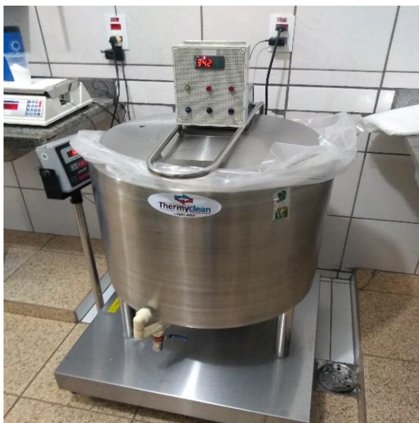
Figura 8. Tanque para preparo do diluente. Foto: arquivo pessoal.
