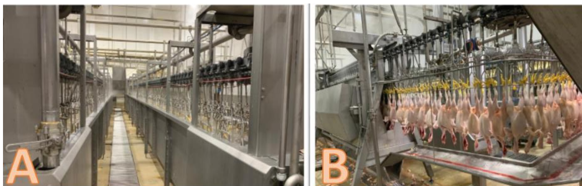
Figura 4: (A) Nóreas imersas nos tanques de escaldagem. (B) Depenadeiras, saída das aves da depenadeiras, pelas nóreas.
