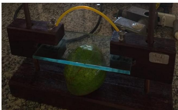
Figura 13 – Aplanador sendo usado para análise de pressão de turgescência no fruto do abacate. Fonte: OLIVEIRA, 2020.
