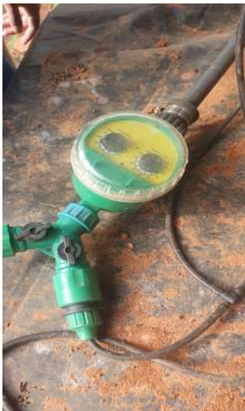
Figura 3: Temporizador e controlador eletrônico para irrigação. Fonte: Autor, 2024.
